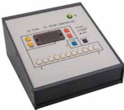
经由LAN线与CS主机连接,一键即可存储、读取CS主机内所存储的设置条件。
